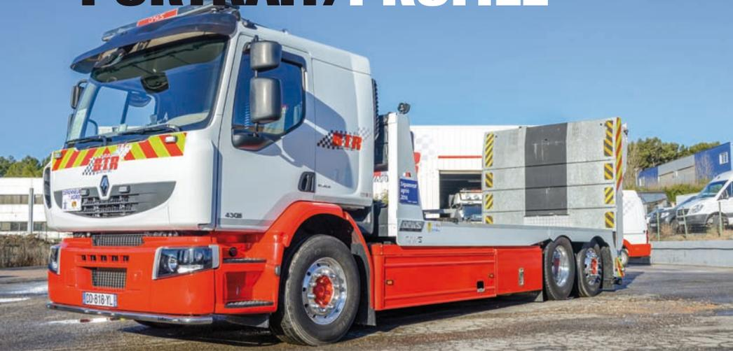
Ce plateau de 14 t de capacité sans porte-à-faux Ar est capable de charger un autocar. Facile et rapide à mettre en œuvre, il remplace une semi porte-engins. This 14 t capacity platform with no rear overhang can carry a coach. Quick and easy to put to work, it replaces a heavy equipment transport semi-trailer.
